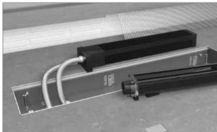
Гибкие шланги из нержавеющей стали (15 - 25 см) позволяют полностью вынимать внутренний механизм для удобства очистки.
